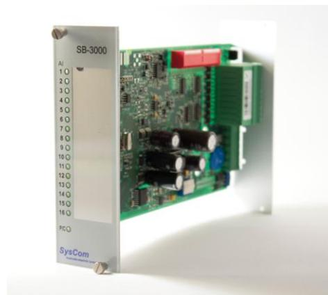
Die Eingänge sind durch einen individuell bedruckbaren, vorgefertigten Einsteckstreifen beschriftet. Dieser wird hinter die Plexiglasscheibe der Modulfront gesteckt. Der Einbau des Automationsmoduls SB-3000, sowie aller anderen Schaltschrankbaueinheiten des SysCom Systems erfolgt in ein 19" Standard-Rack.
