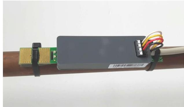
Der Fühler arbeitet mit einem resistiven Sensor:
