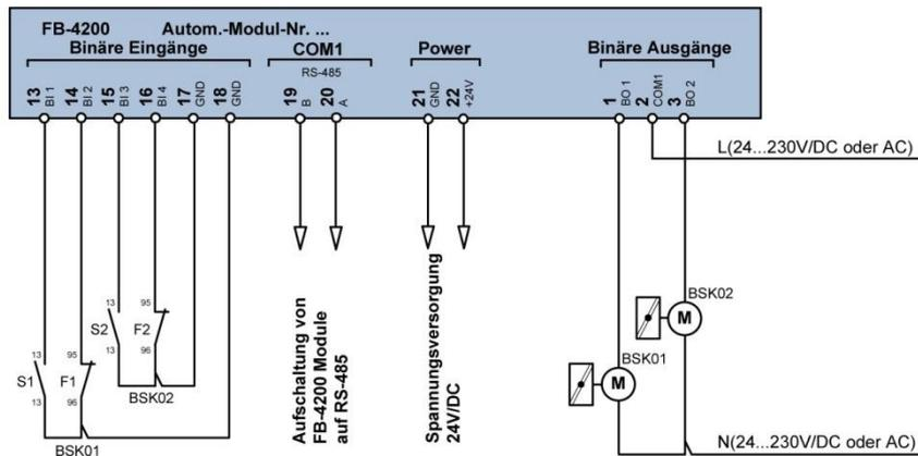
Speisespannung der digitalen Ausgänge von 12V AC/DC bis max 230V AC
