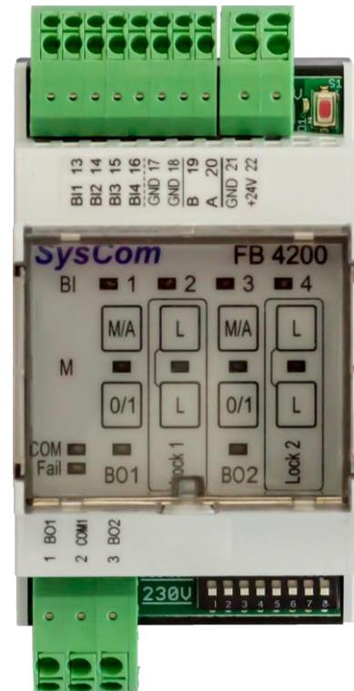
Die Stecker bestehen aus hochwertigen und wartungsfreien, jeweils 2-poligen Federzugklemmen. Ein Öffnen ist möglich, zum komfortablen Anschluss aber nicht nötig (push-in).
